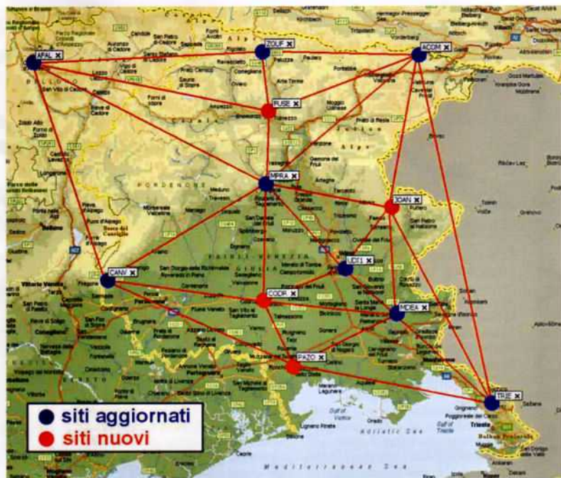
Figura 5: Schema della rete GPS realizzata. I cerchi blu rappresentano i siti della rete FReDNet che sono stati aggiornati con nuova strumentazione GPS e con nuovi apparati radio per la trasmissione dei dati. I cerchi rossi sono invece siti permanenti realizzati ex-novo
